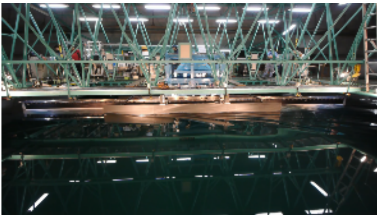
14m 長尺平板試験の様子
