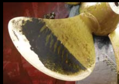
12ヶ月経過 (セメント船、462GT/12ノット)
